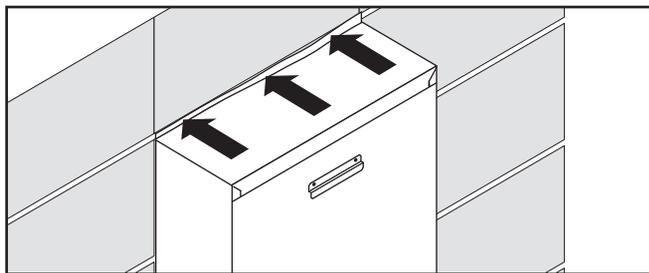
① 本体との隙間にバックアップ材を詰め、コーキングで仕上げます。
