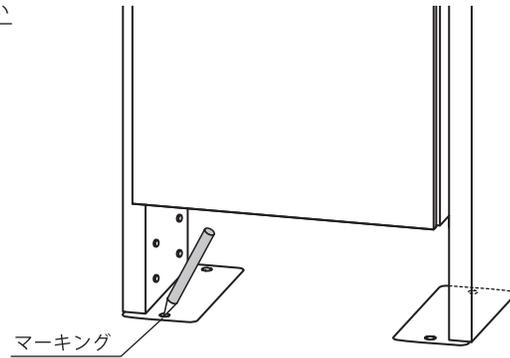
⑥ コンクリートにアンカー用の下穴(φ14mm深さ45mm)を開け、
