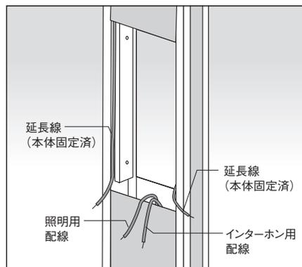
②本体内部に固定済みの延長線と、照明配線・インターホン配線を接続して下さい。照明配線とインターホン配線の区別がつくよう片方の配線にマーキングして下さい。
