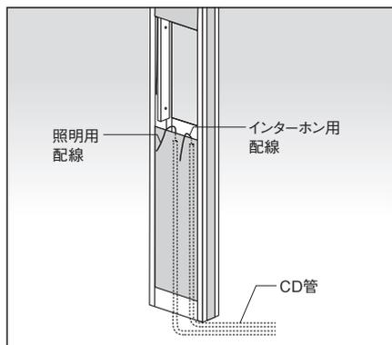
①埋込みポストの取り付け前に、渡り配線を行います。ポスト施工後の配線作業はポストを取り外してから行って下さい。
