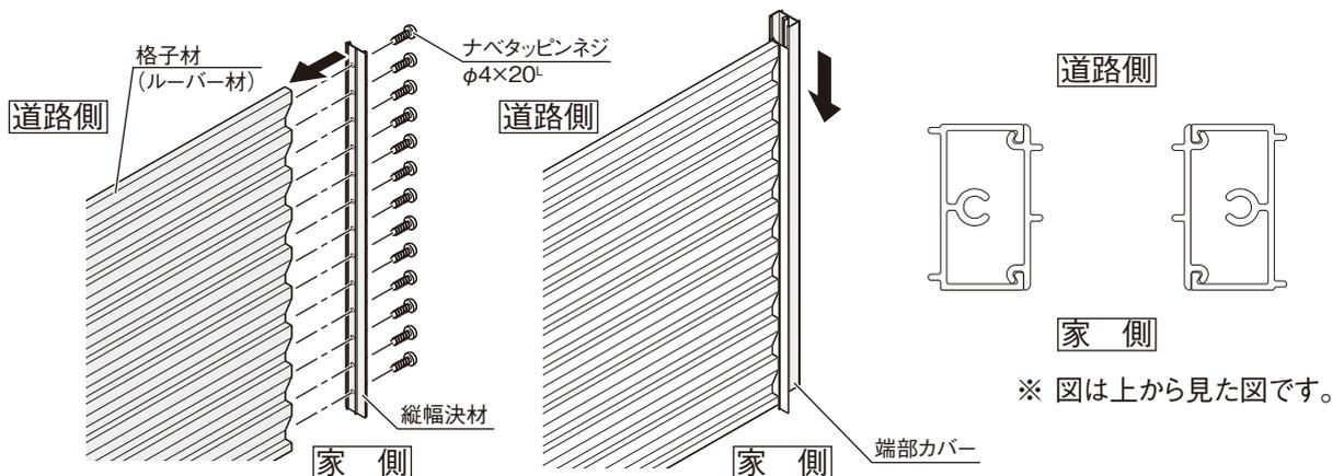
3. 横取付材を角座金とナベタッピンネジ $\phi 4 \times 20$ で取りつけてください。
