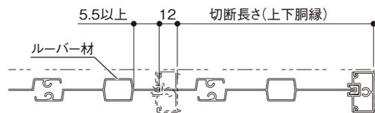
ご注意:ルーバー材切断位置は、凸部より5.5mm以上平面部を残して切断してください。
