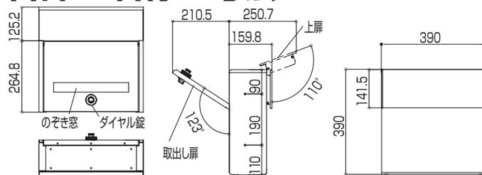
**埋込み施工の場合 (建築用コンクリートブロック・RC コンクリート構造のみ)** **変更**
