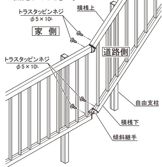
注) 傾斜継手取付部の格子の隙間を少なくする場合は、角度に応じて上棧・下棧の端部を切断してから接続してください。
