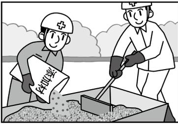
● 添加材を②に投入し、均一になるまで十分に混ぜ合わせます。これを上塗材とします。
