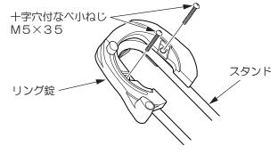
※ねじの締めすぎに注意してください。 ねじを締めすぎると錠前取付金具の 変形、破損につながります。 ②リング錠がしっかり固定されていることを 確認し、六角ナットを付けてください。
