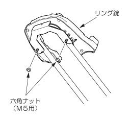
ねじの緩み、リング錠本体がしっかり固定されているか確認してください。 ご使用前にリング錠が作動するか確認してください。
