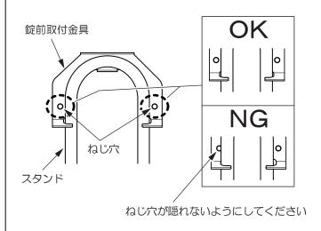
③錠前取付金具の先端を持ち上げ 十字穴付タッピンねじを取付け ます。
