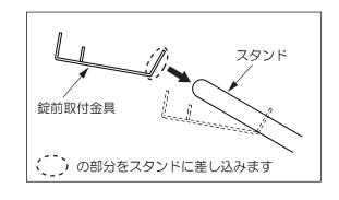
②錠前取付金具のねじ穴が見えるように 左右の位置を調整します。
