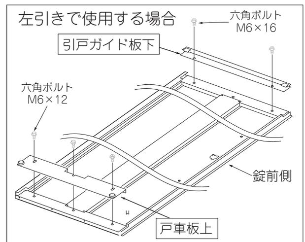
**⑩ 引戸の組立** ~引戸に戸車板上、引戸ガイド板下を取付し、正面柵へ取付けします。
