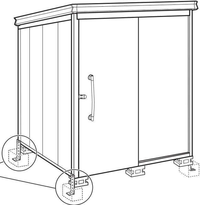
四隅にアンカープレートを取付け、穴を掘り、コンクリートを流し込んでください。
