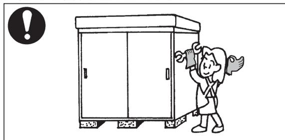
アンカー工事などの転倒防止工事は必ず行ってください。
