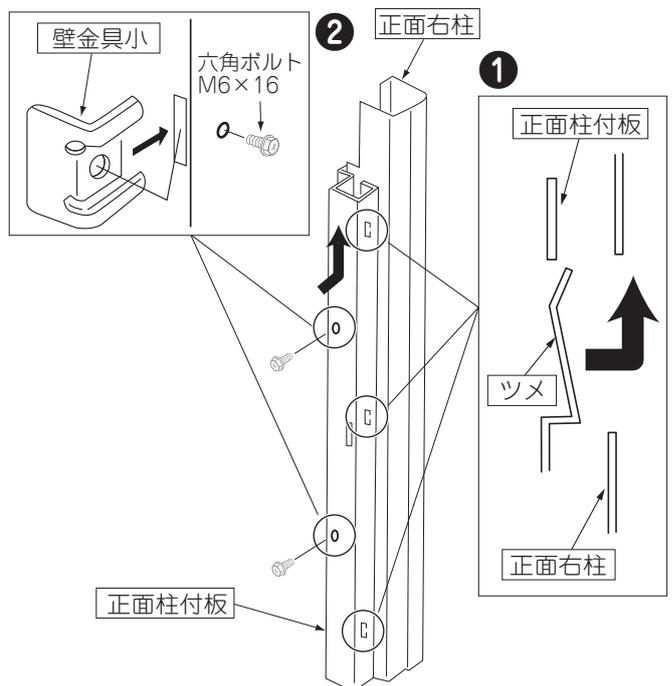
●柱に柱金具を取付けします。
