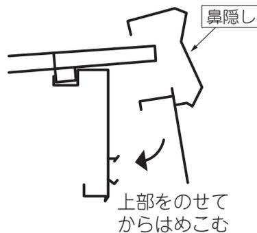
●正面桁裏側よりねじ止めします。
