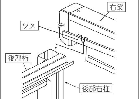
左・右梁の内部側のツメを柱の上に引っ掛けてからビス止めしてください。
