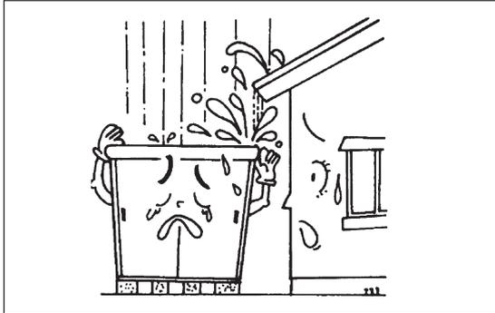
屋根から雪が直接物置に落ちない場所へ設置してください。
