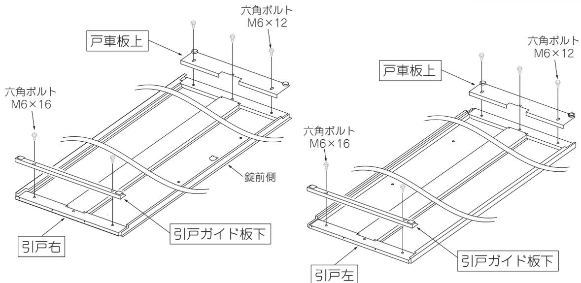
**⑩ 引戸の組立** ~引戸に戸車板上、引戸ガイド板下を取付し、正面柵へ取付けします。
