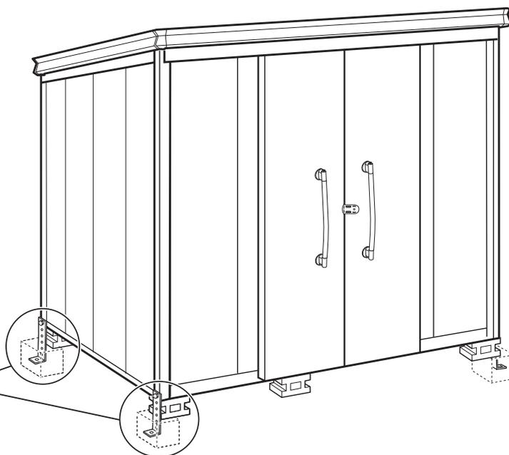
四隅にアンカープレートを取付け、穴を掘り、コンクリートを流し込んでください。
