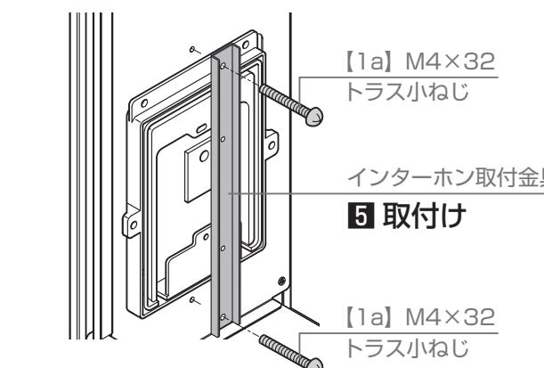
6:②で取外した側面カバーを①のねじで取付け
