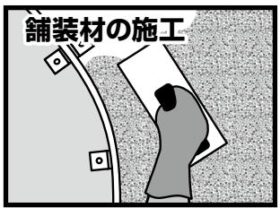
目地棒で区分けされた舗装面を、プライマー塗布後にそれぞれお好みの舗装材で施工すればOK。
