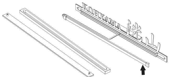
⑤表札本体を元に戻し、結線をしてください。点灯確認を行った後、台座へ表札を固定します。
