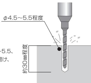
電動ドリル等でφ4.5~5.5、深さ30mm程度の穴を開け、壁面と穴の中を綺麗に掃除して下さい。
