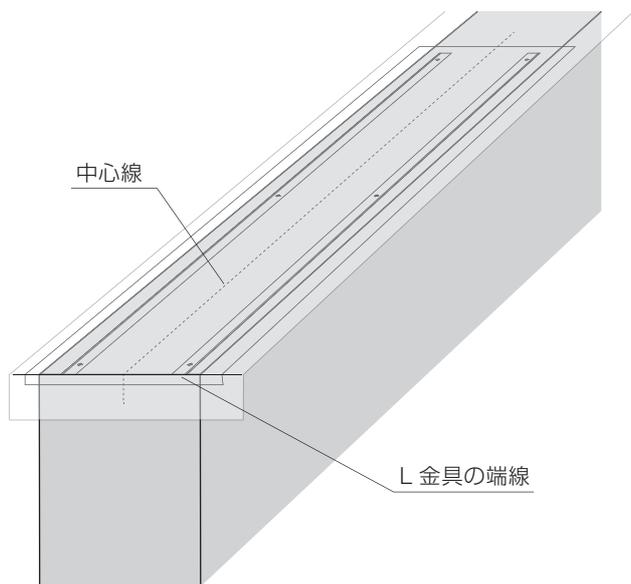
同梱の取付原稿を左図のようにあわせ、印を付けて穴をあけます。
