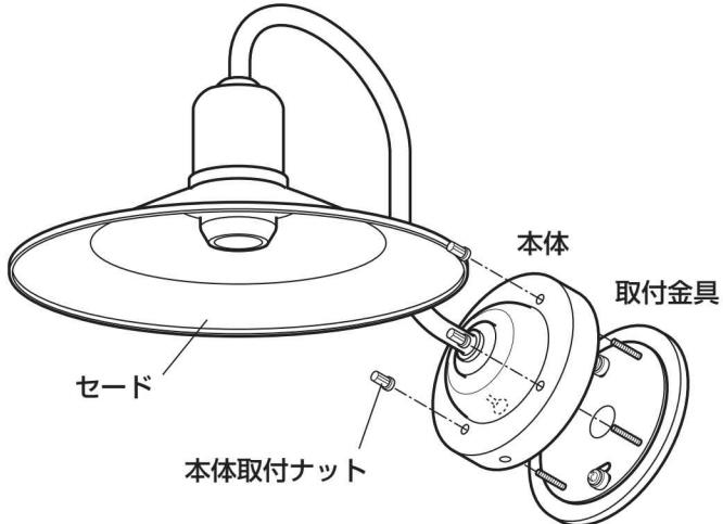
本体の穴に取付金具のねじを通して、本体取付ナットで固定してください。
