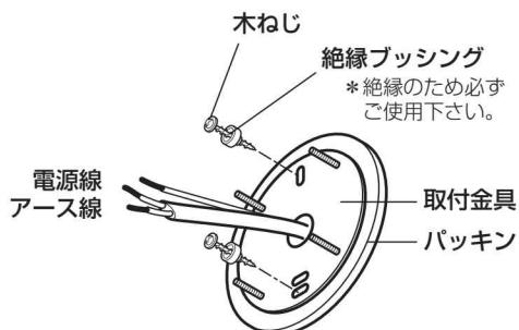
電源線とアース線を電源穴に通してから、付属の絶縁ブッシング・木ねじで取り付けてください。
