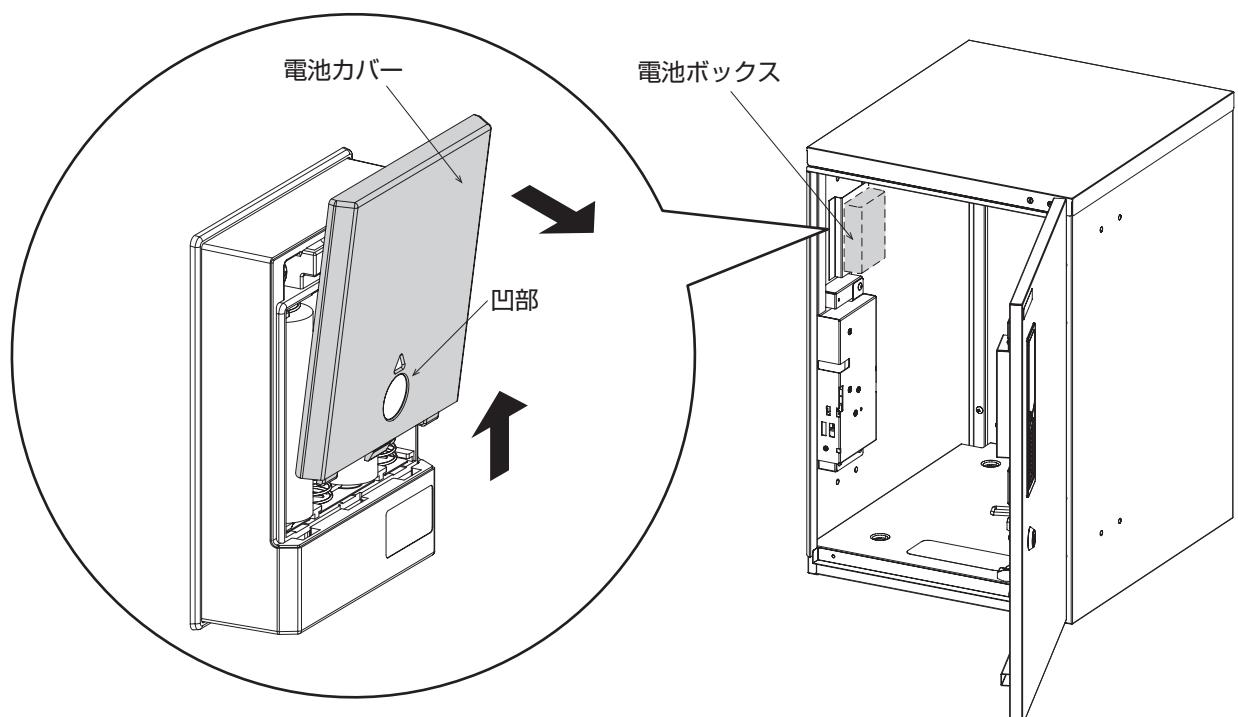
**2** 同梱の単3形リチウム乾電池を電池ボックスに入れてください。
