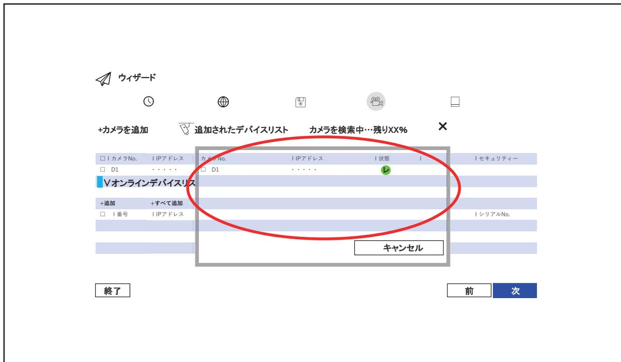
カメラとモニターの接続が完了しますと赤○内の様に表示されます。「状態:緑色」接続される台数が全て表示されれば接続完了になります。(何度か行って頂く場合も御座います。)「×」で閉じて頂き、右下「次」を選択。
