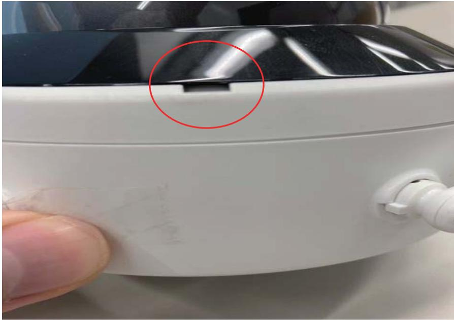
2. ネジ3カ所をプラスドライバーで外して頂き、カバーを外してください。
