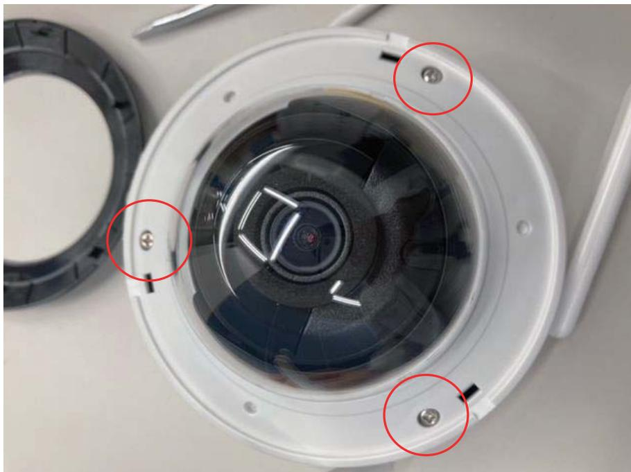
3. カメラ本体を回して頂ければ方向変更できます。
