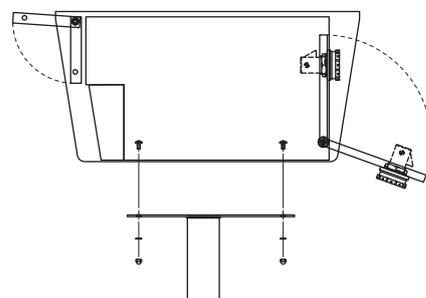
②右図のようにスタンドポールに同梱部品の寸切りボルト (M8×L200) をナット (M8) で固定します。
