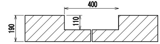
①化粧ブロックを2個、上図寸法のとおりカッターにてL字に切り欠いて下さい。
