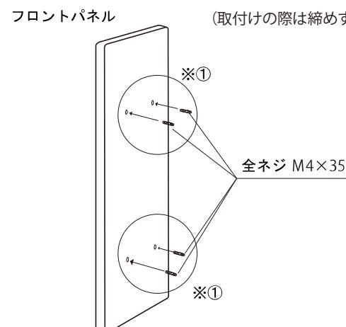
(取付けの際は締めすぎにご注意ください。工具を使用せず手締めにて行って下さい。)
