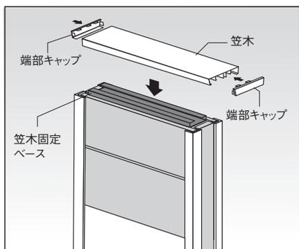
笠木固定ベースに笠木を取り付けた後、同梱品の端部キャップを取り付けます。
