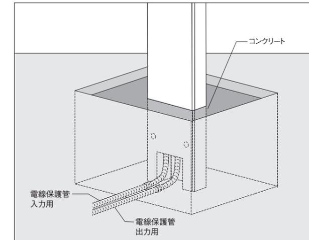
④電気配線・器具の取り付けを行います。コンクリート養生後に上部開部へ市販の外部コンセントを取り付けます。
