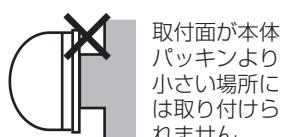
※凹凸のある面に取り付ける場合は必ず防水シール材で隙間を埋めてください。
