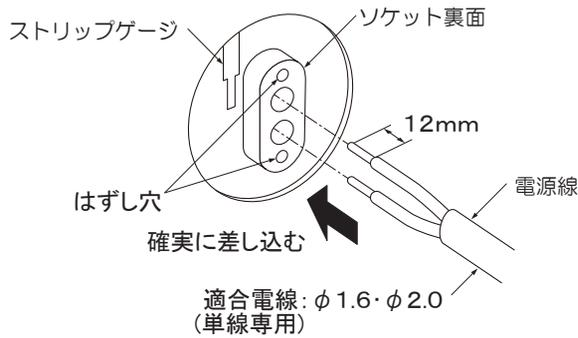
電源線を取外す場合は、先端を20mm以上段むきしたφ1.6VVF線を2本同時にはずし穴に押し込みながら、電源線を引き抜く。
