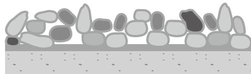
施工断面に空隙が多く、仕上面に骨材が立っているなど凹凸がある。(脱石やハガレの原因となります。)
