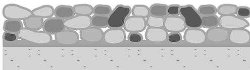
施工断面が骨材で密に充填されており、仕上面も平滑である。
