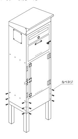
図を参考に脚を付属のなべネジを使って本体に取付けてください。 脚1本につき、なべネジ6個を使って取付けます。
